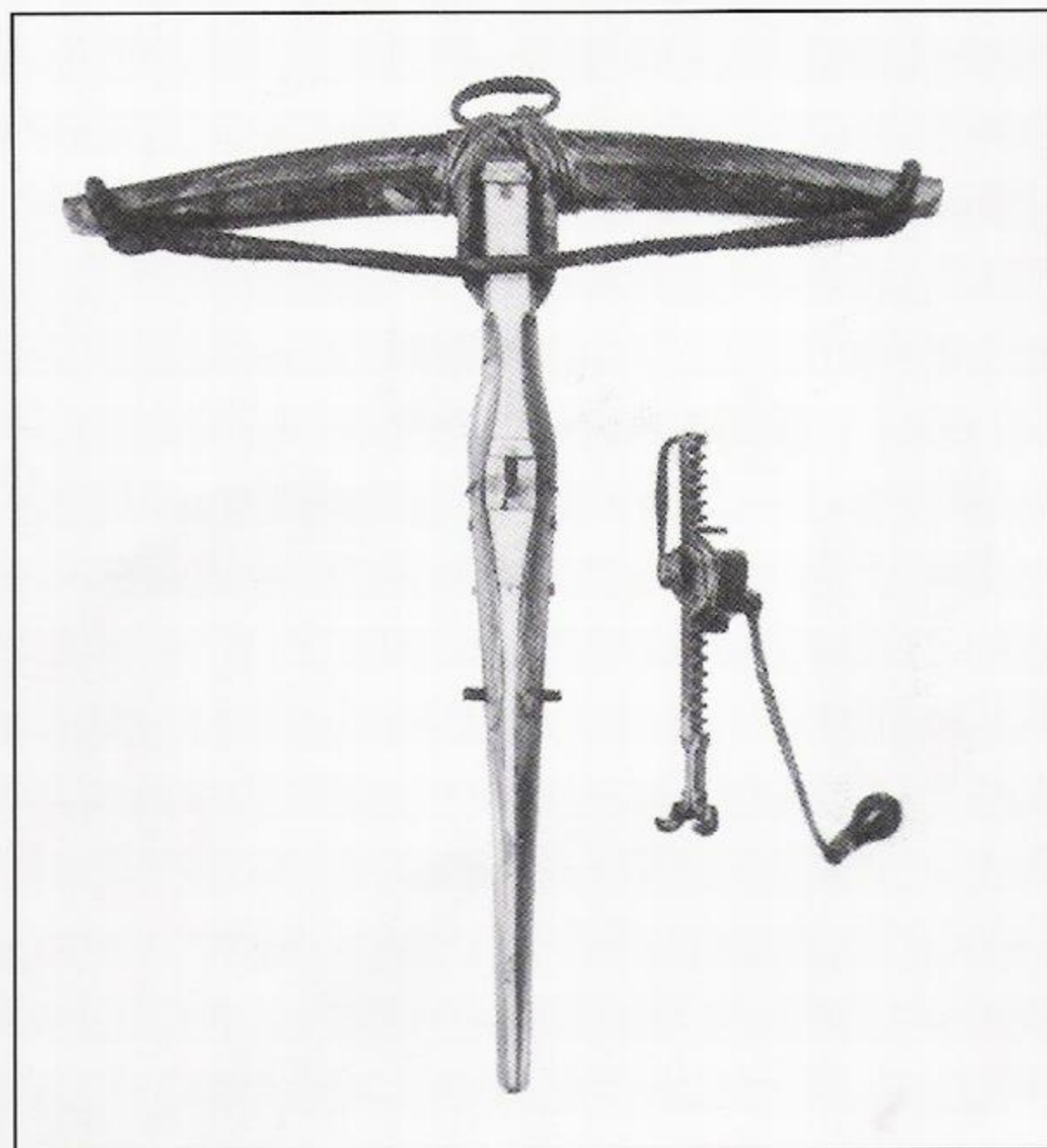
Ballesta y cranequín que datan de finales del siglo XV. Es un arco compuesto y está cubierto de pergamino, la cureña está hecha de cuerno, y la cuerda es original. El uso del cranequín mecánico era un método de carga muy popular en Alemania. El cranequín se monta sobre la cureña y el mecanismo se carga por la acción de una pinza.
